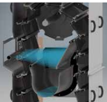
Sprühbalken zur Plattenreinigung
